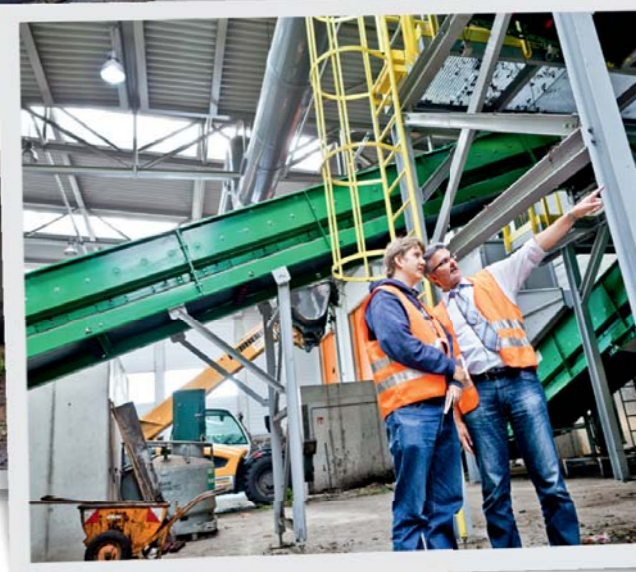
DIE BÄNDER FÜHREN QUER DURCH DIE HALLE ZU EINER TROMMEL, WO DER MÜLL GESIEBT WIRD.
