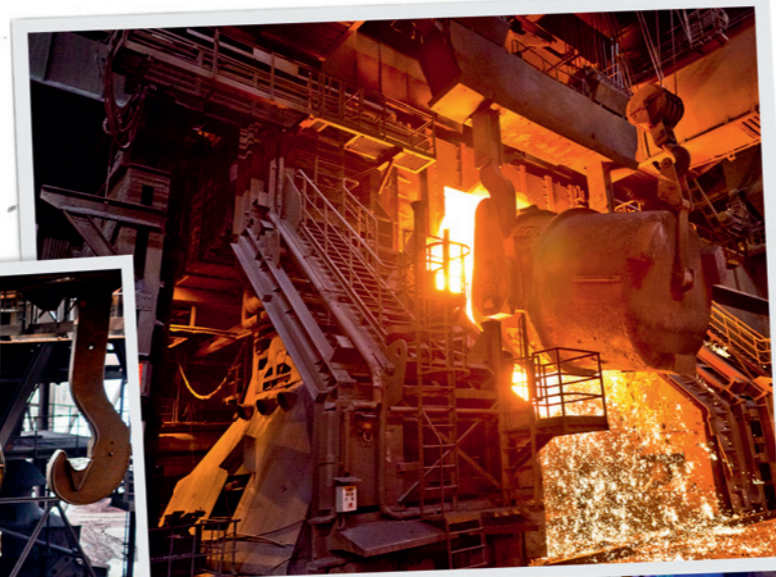
WENN DAS ROHEISEN ZU STAHL GELACHT WIRD, KOMMT DER SCHROT ZUR KÜHLUNG DAZU.
