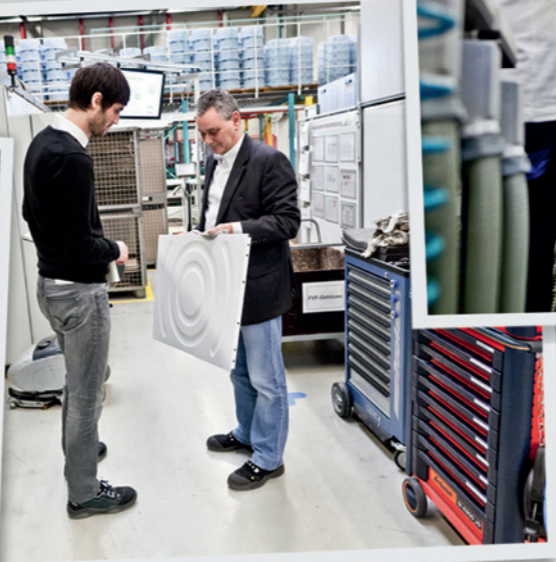
IN NAUEN WERDEN DIE BLECHROLLEN WIEDER ABGEWICKELT, ZUGESCHNITTEN UND DANN DIE SEITENTEILE DER WASCHMASCHINEN DARAUS GEMACHT.
