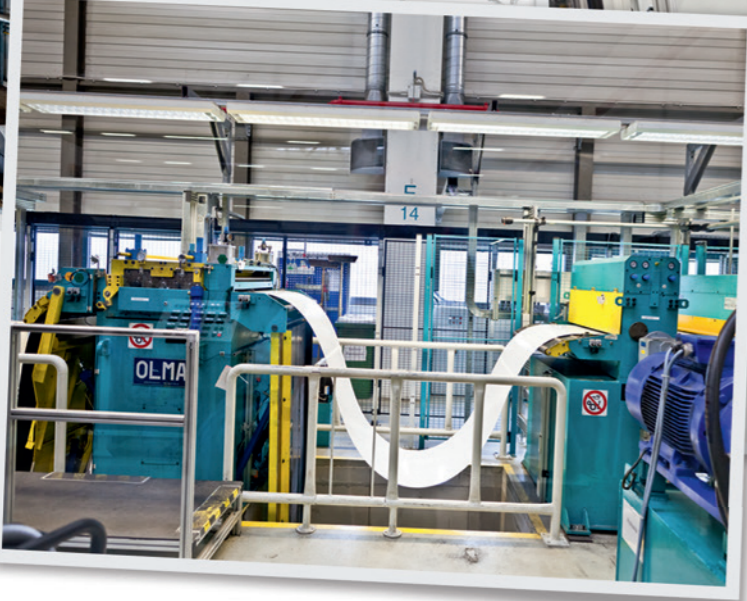
IN NAUEN WERDEN DIE BLECHROLLEN WIEDER ABGEWICKELT, ZUGESCHNITTEN UND DANN DIE SEITENTEILE DER WASCHMASCHINEN DARAUS GEMACHT.
